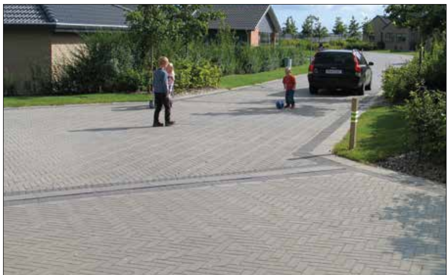
På mindre boligveje med begrænset biltrafik kan det i nogle tilfælde være fordelagtigt ikke at adskille de forskellige trafikformer og på den måde skabe et totalmiljø på de „bløde“ trafikanters vilkår. Etableret i 2007 (Galten).
